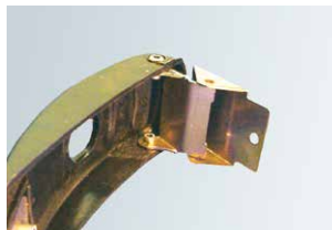
Trinquete de material compuesto para el tapacubos
