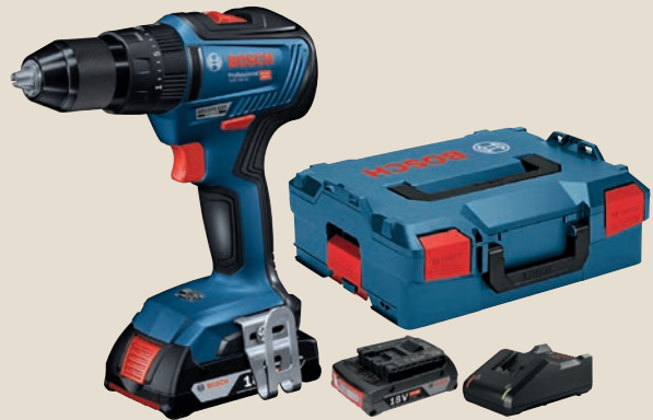
TALADRO PERCUTOR BATERIA 9711386 18V, 3 Ah, Motor BRUSHLESS. ECP. EMP. 2 Velocidades (0-450/1.750 rpm). 55/28 Nm. 20+1. Portabrocas de 13 mm. 0 - 27.000 ipm. Luz LED. Ø Máx. tornillo: 8 mm. Ø Máx. perforación en madera: 35 mm.
