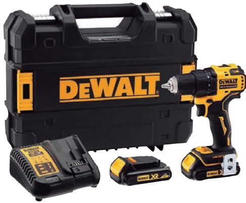
TALADRO PERCUTOR XR 18V 9712976 Portabrocas 13mm Par máximo 42Nm Velocidad sin carga 0-450 / 1.500 rpm Impactos 0-7.650/25.500 ipm Incluye 2 baterías Li-Ion 2Ah y maletín TSTAK
